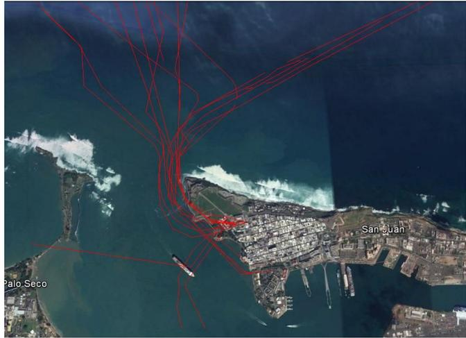
Fig.2 Mapeo GIS de Global Marine con posibles cables de telégrafos submarinos en la Bahía de San Juan, Puerto Rico.
