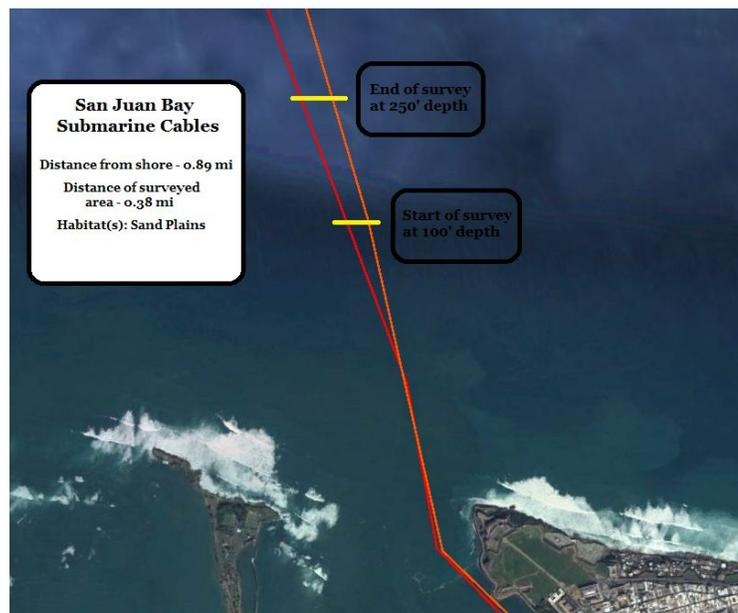
Fig.5 Mapeo GIS de Global Marine demostrando el área investigado de los cables submarinos de telégrafo afuera de la Bahía de San Juan.
